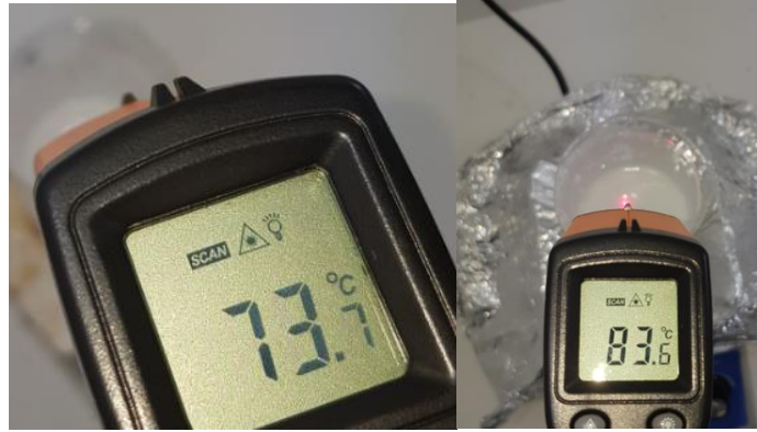
Şekil-16- Sülfirik ve nitrik asitle sıcaklık kontrollü nitrolama işlemi.
