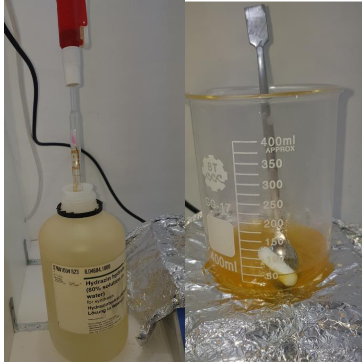
Şekil 23- Çeker ocak içerisinde gaz maskesi takılarak %80 lik hidrazin çözeltisinden 40ml %8 lik çözelti hazırlandı ve 3-nitroftalik asit ile manyetik karıştırıcıda katı çözününceye kadar karıştırıldı.
