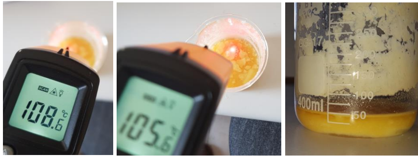
Şekil 29- 3-Nitroftalidhidrazit çözeltisinin soğutulması ve çökelek oluşumu.
