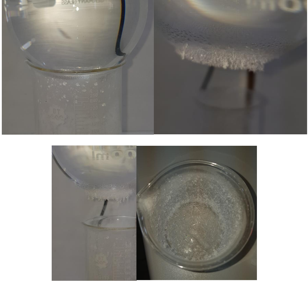
Şekil 12 : Ftalik anhidritin süblimleştirilerek saflaştırılması
